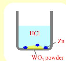
図2 H<sub>x</sub>WO<sub>3</sub>試料作成
