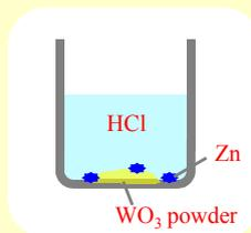
図2 H<sub>x</sub>WO<sub>3</sub>試料作成
