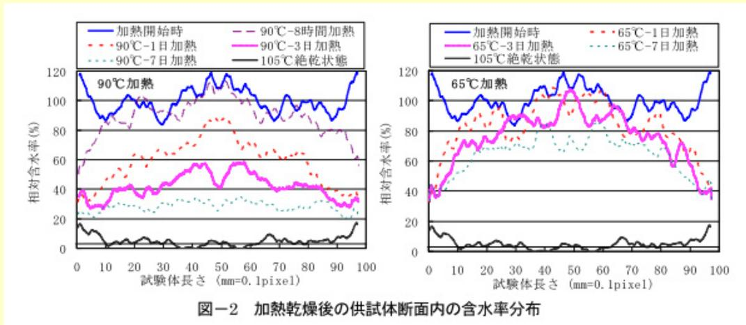
図-2 加熱乾燥後の供試体断面内の含水率分布
