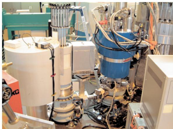
図1 10T超伝導磁石を搭載したTAS-2
