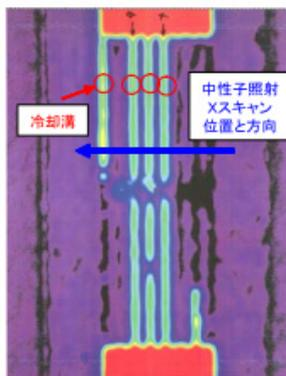
図4 超音波検査の結果
