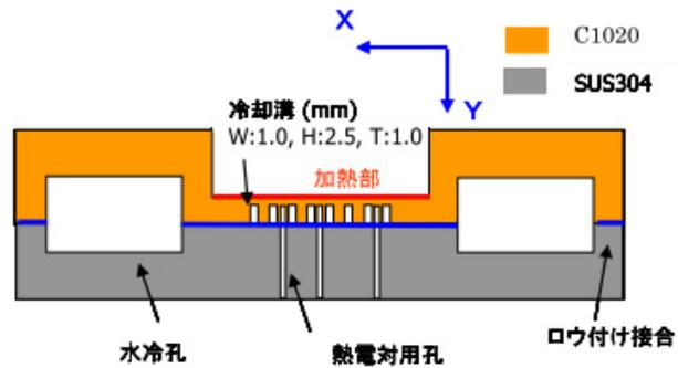
(b) 冷却溝部断面構造
