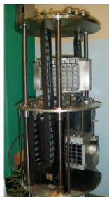
偏極用ホイスラーとPGモノクロを電動エレベータで駆動して切り替え可能
